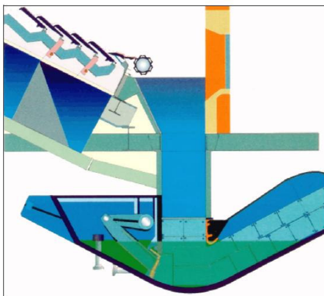
2.3.3 ábra: Példa a rostélytüzelésű hulladékégetőben használt salakkihordókra
