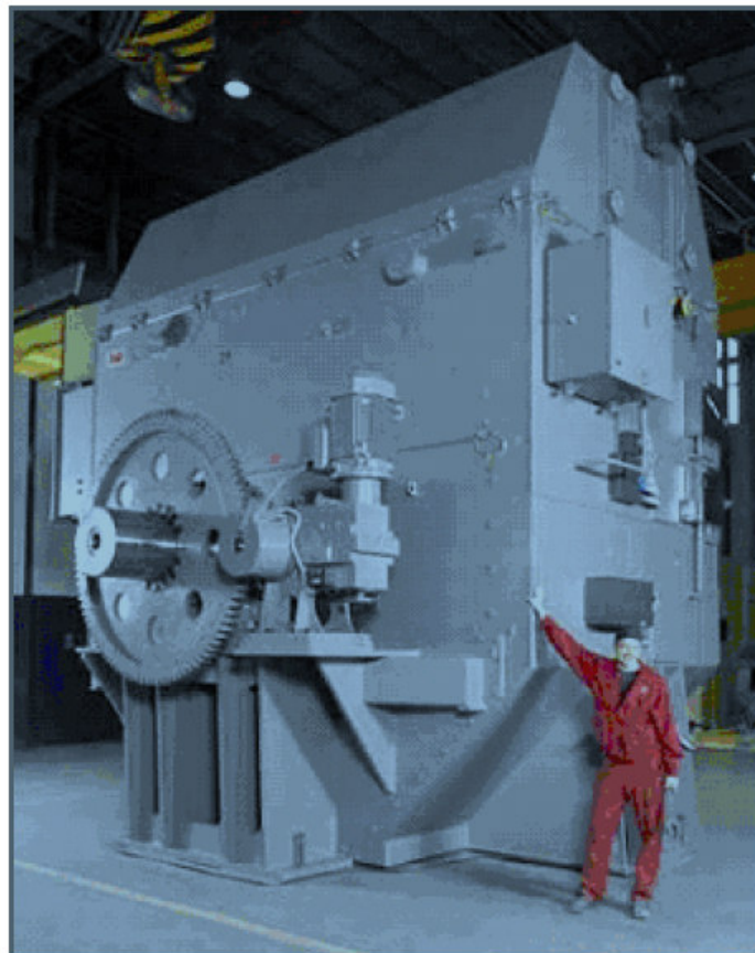
3.36 ábra: 24 MW névleges teljesítményű kompresszor motor
